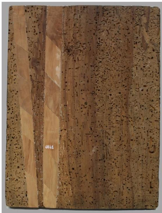
Fig.7: Matrice sottoposta ad un intervento di assottigliamento sul recto, probabilmente per abbassare le tensioni del legno e procedere all'inserimento dei cunei, questa operazione, individuata su svariati pezzi della collezione, ha spesso evidenziato il forte attacco xilofago subito dal legno con la messa in evidenza delle gallerie larvali
