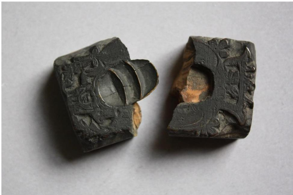
Fig.5: Matrice spezzata in due parti
