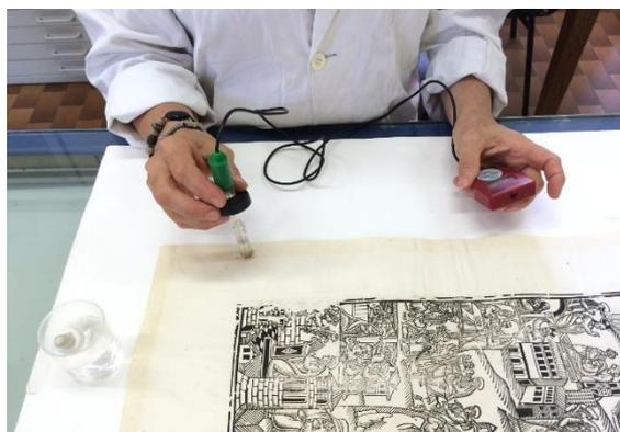
Fig. 16: misurazione pH a campione
